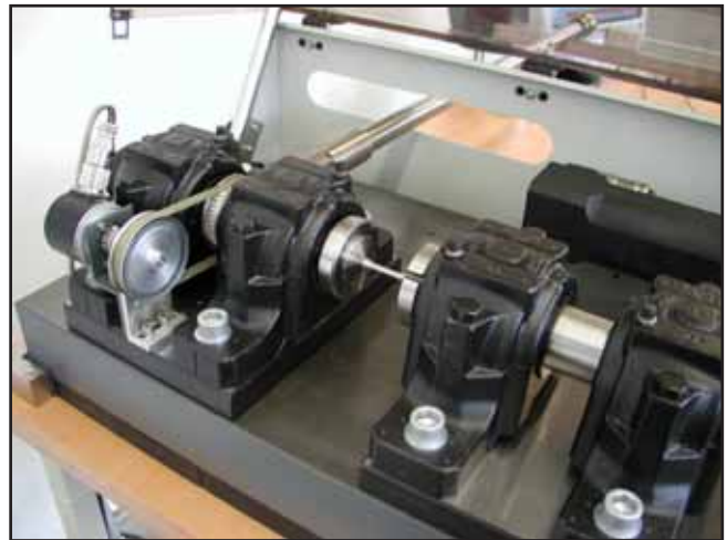
Prüfling im Prüfraum der Umlaufbiegeprüfmaschine
