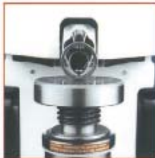
Messung der inneren Lauffläche eines Kugel- lageraußenrings mit 23 mm Durchmesser
